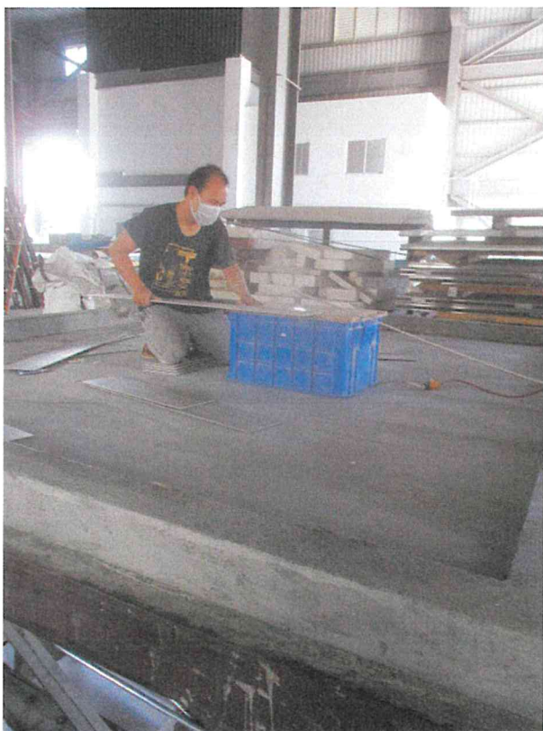
照片 3 試驗件組裝過程(石塑地板裁切)
