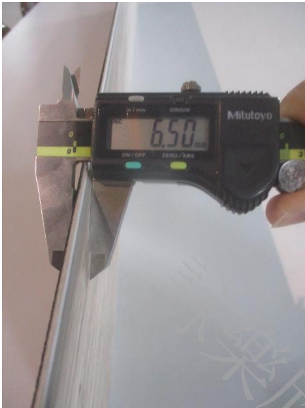
照片 1 試驗件尺寸查核(SPC 地板)
