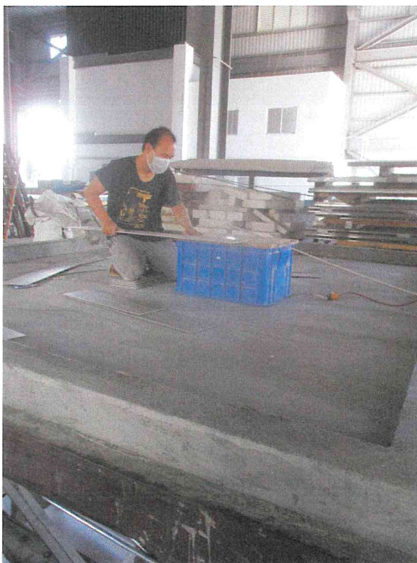
照片 3 試驗件組裝過程(石塑地板裁切)
