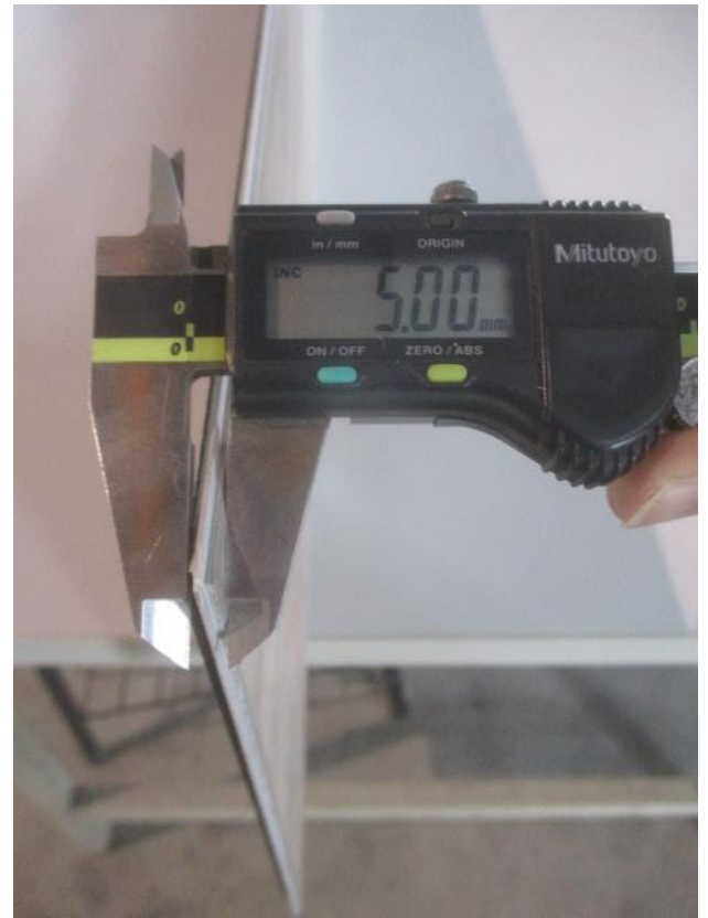
照片 2 試驗件尺寸查核(SPC 地板)
