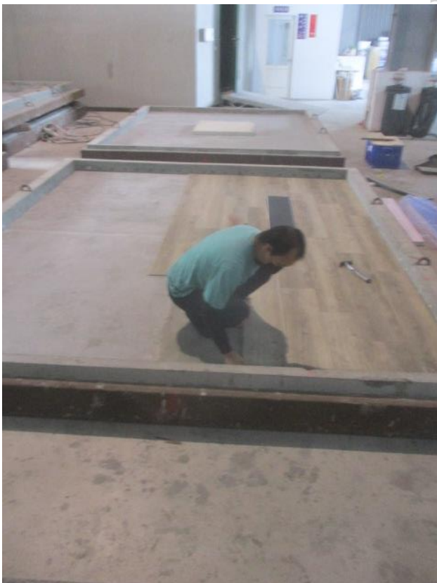
照片 3 試驗件組裝過程(鋪設 SPC 地板)
