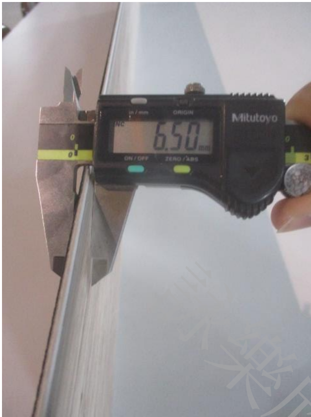
照片 1 試驗件尺寸查核(SPC 地板)
